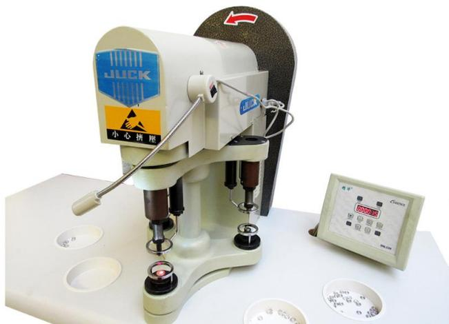
Новый трехпозиционный электромеханический фурнитурный пресс позволяет устанавливать разнообразные виды металлофурнитуры при установке соответствующих насадок. Три зоны установлены на поворотном основании с центральной осью под углом 120 градусов друг к другу. Такое решение позволяет создать максимально свободную рабочую зону вокруг рабочей позиции.
